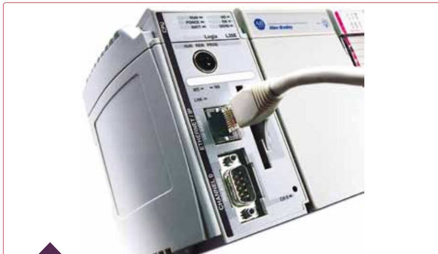
Automates et PC industriels peuvent être déportés au plus près de l'application, même dans un environnement difficile. CompactLogix de Rockwell Automation.
