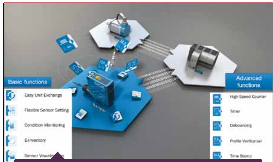
Schéma représentant un réseau d'objets communicants via le protocole IO-Link (Photo Sick).
