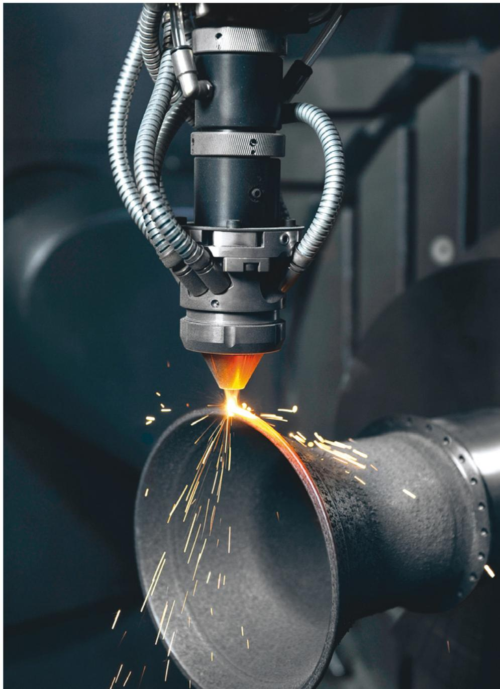
**Machine d'usinage 5 axes doté d'une tête Clad permettant de réaliser des pièces en fabrication additive.**
